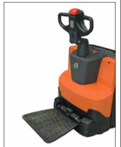
Stupačka pro delší pojezdy. Pro provoz na delší vzdálenosti je dobré vybavit vozíky integrovanou sklopnou stupačkou. Na snímku model BT Levio
