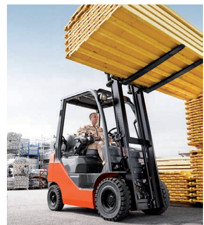
Automatická kontrola zdvihu zabraňuje zbytečné spotřebě paliva způsobené příliš vysokými otáčkami. V případě vozíku Toyota Toneru Optimax není potřeba při zdvihu sešlapovat pedál akcelérátoru – rychlost zdvihu je automaticky přizpůsobena pro maximální efektivitu a nízkou spotřebu
