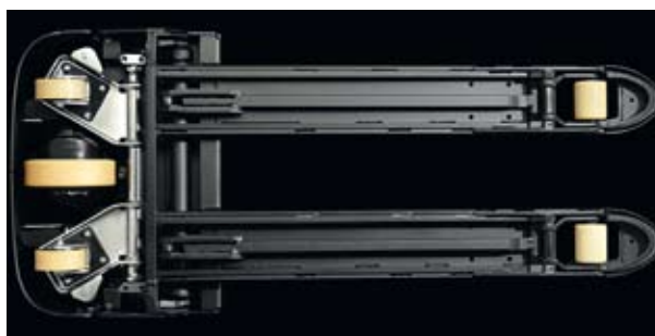
Unikátní pětikolový podvozek BT zvyšuje stabilitu na rampách
