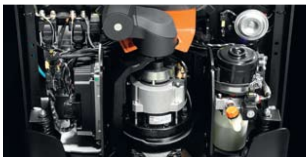
Fixní motor nemá žádné pohyblivé kabely
