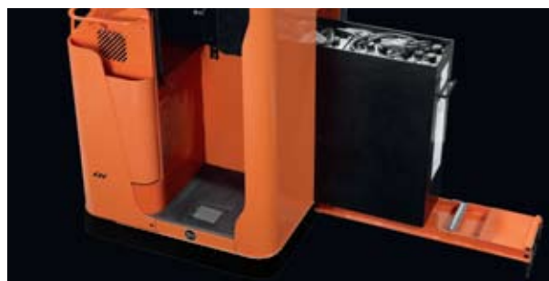
Baterie modelů S-série je uložena na rolně vestavěného bateriového stolu umožňujícího snadnou výměnu z boku
