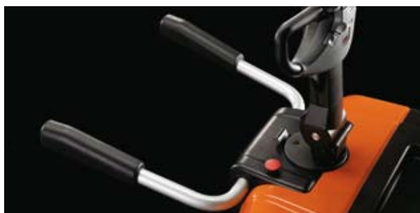
Sklopná boční madla chrání řidiče při zachování výhod sklopné stupačky
