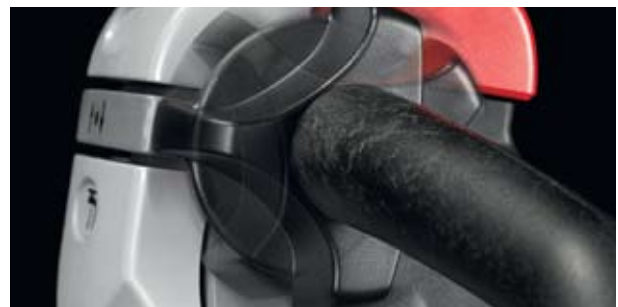
Funkce Click-2-Creep umožňuje manévrování s vozíkem v pomalém módu při zvednutí ovládací rukojeti
