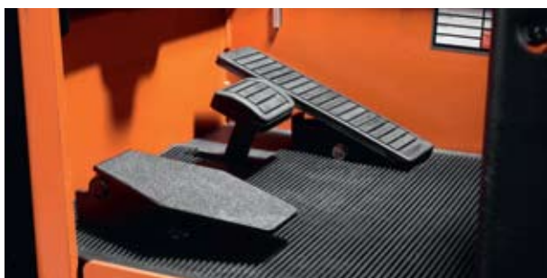
Uspořádání pedálů jako v automobilu zvyšuje bezpečnost a produktivitu
