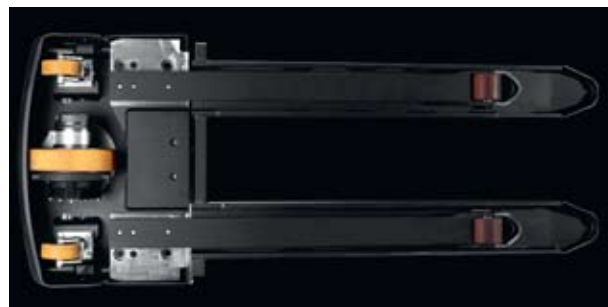
HWE100 má unikátní pětikolový podvozek BT zaručující vynikající stabilitu a kontrolu nad vozíkem
