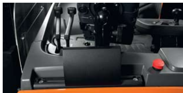
E-bar je univerzální konzole pro zařízení správy skladu, jako jsou PC, datové terminály a čtečky čárového kódu
