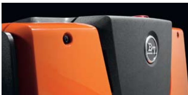
Kapota je pro rychlý přístup zajištěna dvěma šrouby
