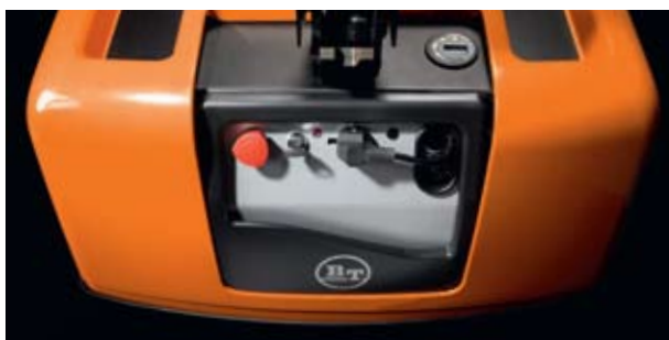
Tlačítko nouzového zastavení a přívod vestavěné nabíječky jsou snadno přístupné pro obsluhu
