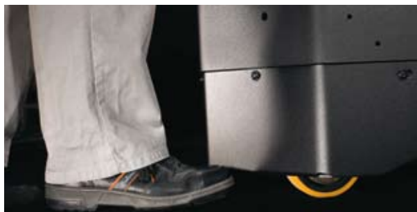
Nízká obruba vozíků P-série chrání nohy řidiče, aniž by omezovala schopnosti vozíku na rampách a jiných svažitéch površích
