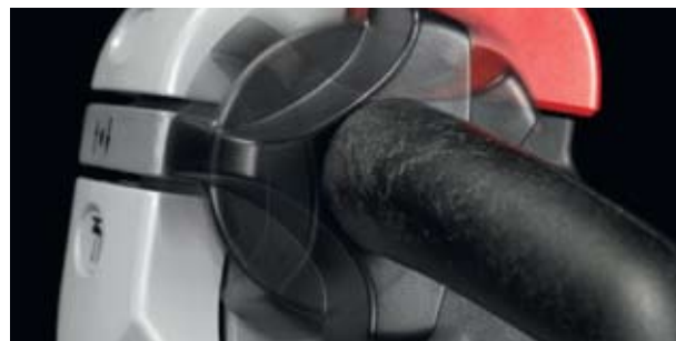
Funkce Click-2-Creep umožňuje manévrování se zvednutou řídicí ojí v pomalém módu
