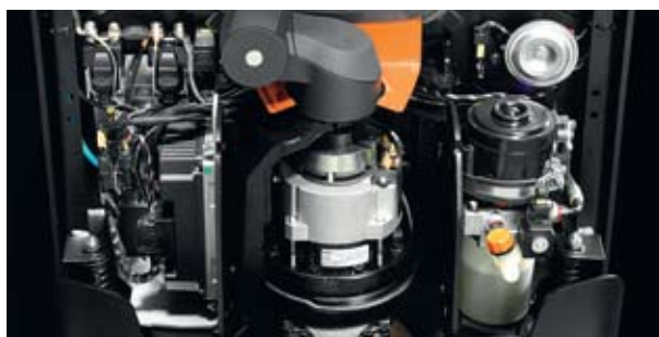
Fixní motor nemá žádné pohyblivé kabely
