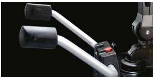
Sklopná madla umožňují LPE200 využít plnou rychlost 8,5 km/h
