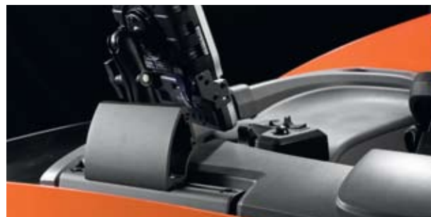
E-bar: univerzální lišta pro montáž zařízení správy skladu, jako jsou například PC, terminály a čtečky čárového kódu
