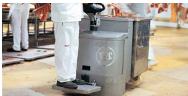
Nerezová ocel zaručuje dlouhou životnost LPE200I v korozivním prostředí
