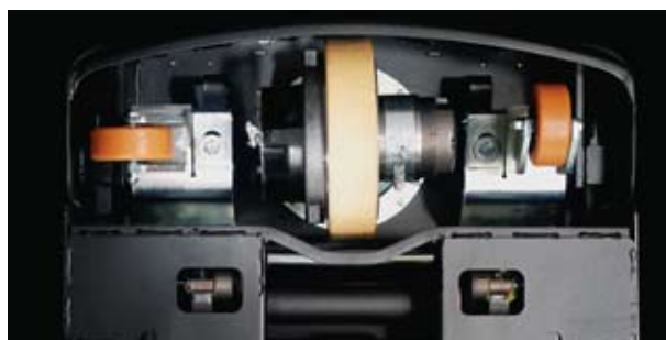
Pětikolový podvozek LWE130 zaručuje optimální stabilitu a ovládání s pomocnými kolečky nevybočujícími mimo půdorys vozíku
