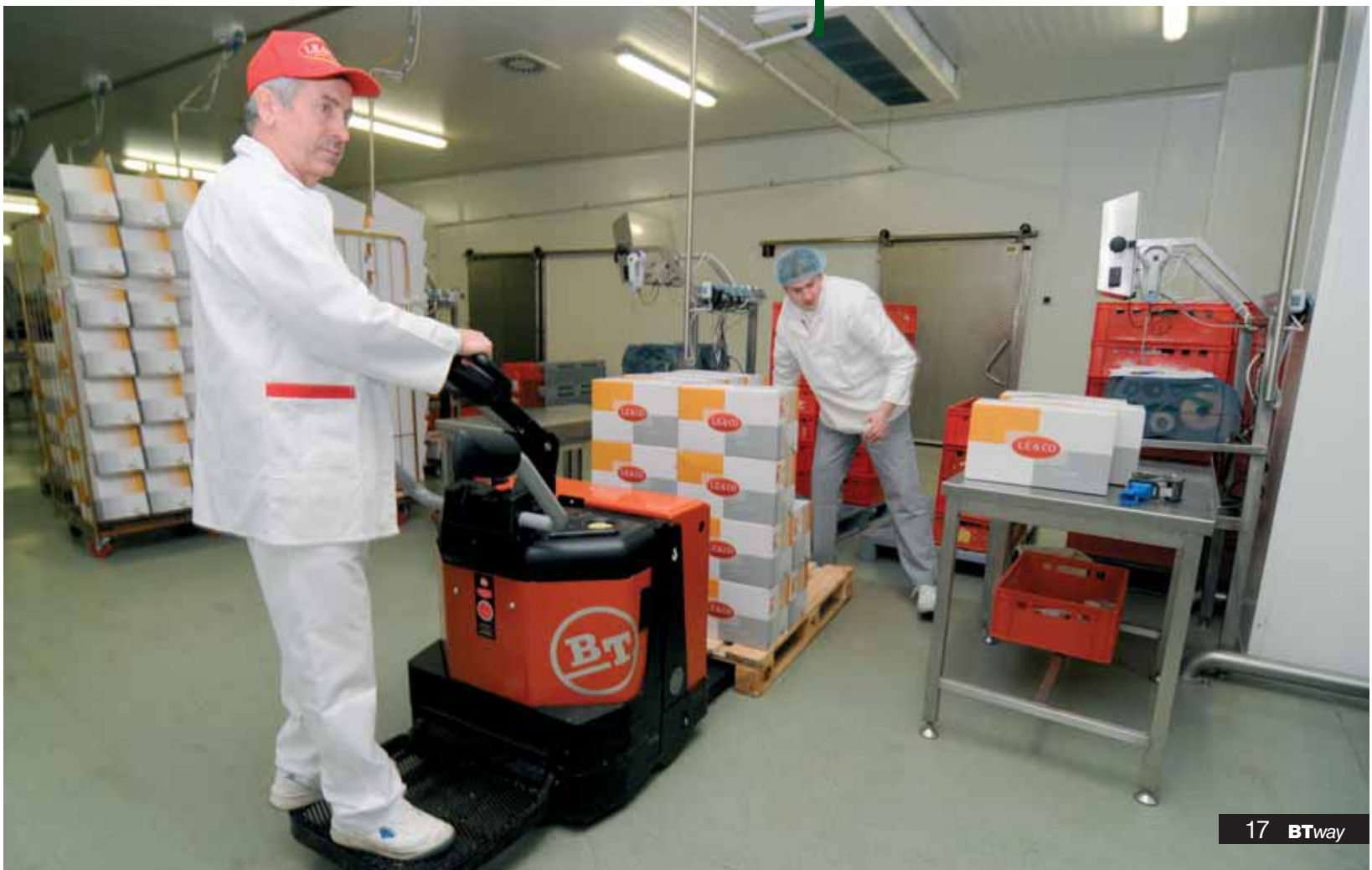
Nízkozdvíhací vozík Orion se sklopnou stupačkou urychluje manipulaci
