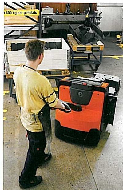
BT Levio s centrálně umístěnou řídicí ojí nabízí jednoduché ovládání (pro praváky i leváky)
