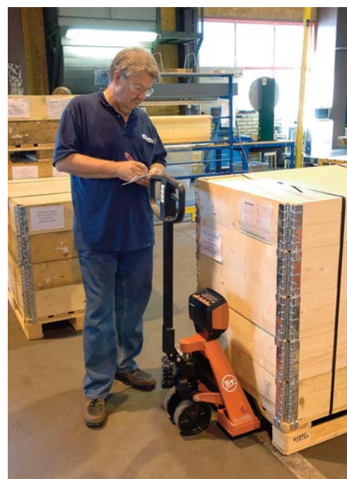
Paletový vozík s váhou spojuje výhody přesného vážení s mobilitou a flexibilitou manipulační techniky.
