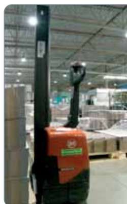
◀ Speciálně upravený vozík BT LPE240 přiváží roli k upínacímu zařízení řezačky
